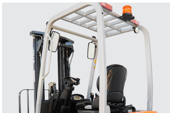
Amplio campo de visão no teto da cabine do operador garante boa visibilidade da carga no alto.
